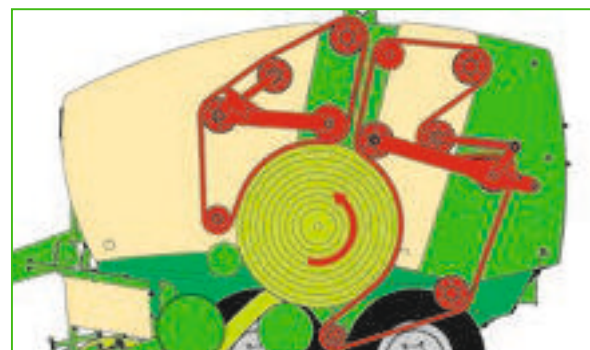
Zmienna komora prasowania (V 1500 i V 1800): oba pracujące na obwodzie przenośniki łańcuchowo listwowe formują bele o wysokim stopniu sprasowania.
