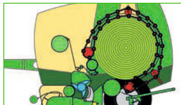
Zmienna komora prasowania (V 1500 i V 1800): oba pracujące na obwodzie przenośniki łańcuchowo listwowe formują bele o wysokim stopniu sprasowania.
